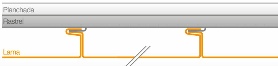
Les lames TE trouvent généralement appui sur une sous-structure formée par des supports ou tasseaux métalliques.
